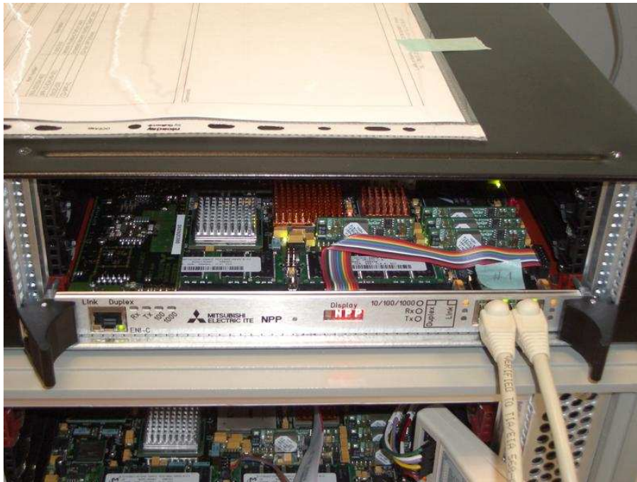
FIG. 2.3 – La carte NPP en fonctionnement dans un chassis
